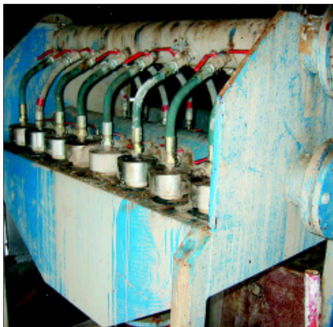
Obr. 1. Cyklony na separaci částic saturačního kalu
