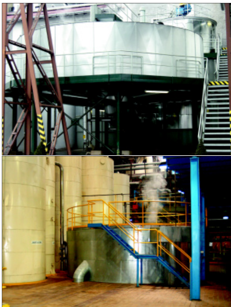
Obr. 2. Dekantéry v cukrovaru Dobruška (horní fotografie) a Opava (dolní)
