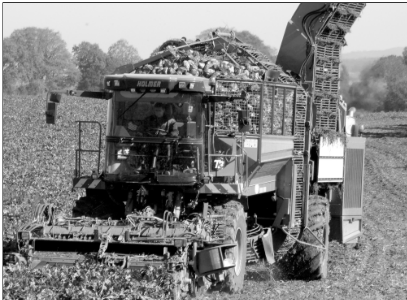
Obr. 4. Šestiřádkový sklízec cukrovky Holmer Terra Dos T3
