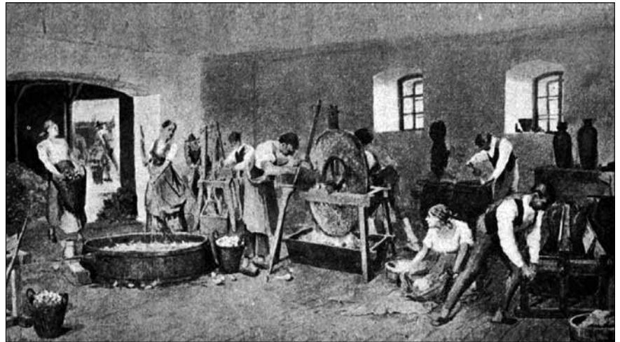
Obr. 1. Vyobrazení výroby cukru okolo roku 1812: praní a krouhání řepy, lisování kaše
