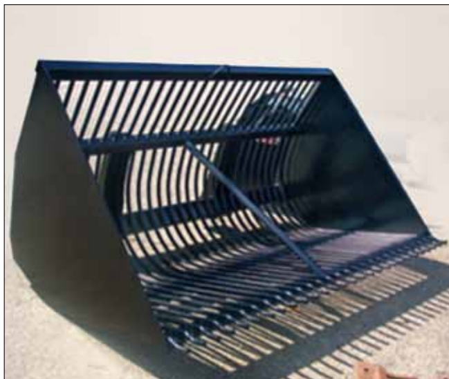
Obr. 6. Radlica vhodná na manipuláciu s cukrovou repou
