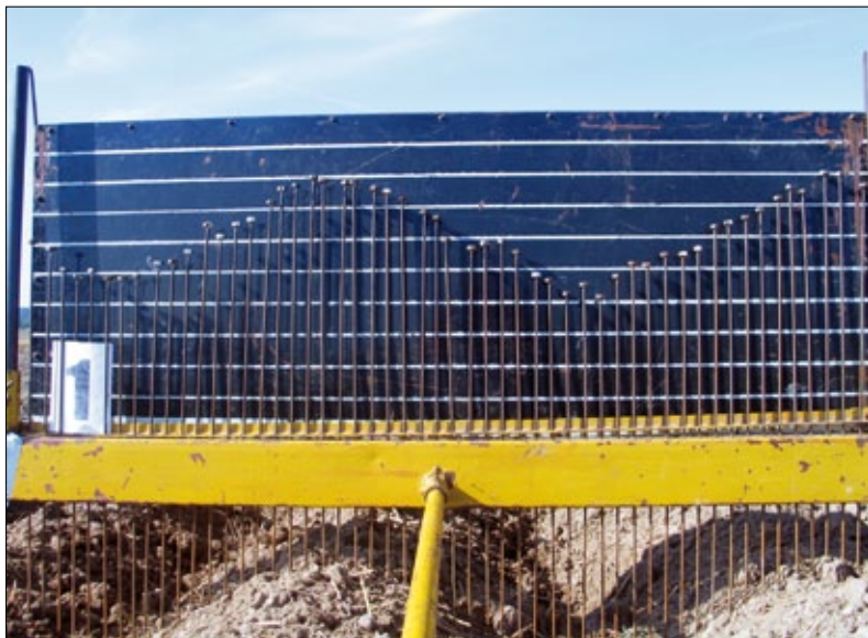
Obr. 2. Drátový profilograf při měření příčného profilu povrchu hrůbků
