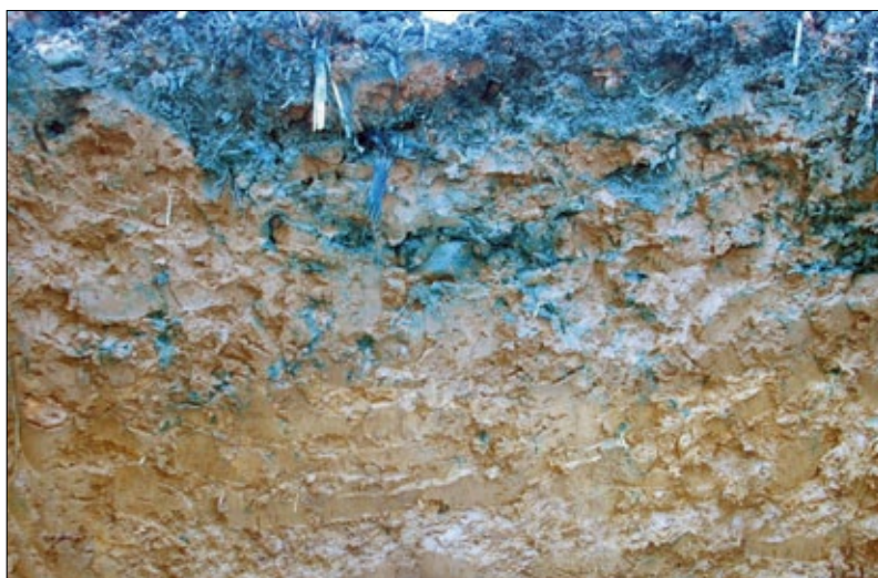
Obr. 4b Vyznačené preferenční cesty vsakování vody do půdy při modré infiltraci na stanovišti s plošným kypřením na podzim po sklizni kukuřice do hloubky 150–200 mm
