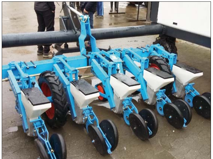
Obr. 4. Ukázka zavěšení pracovní sekce na stroji Agrobotelli Robotti
