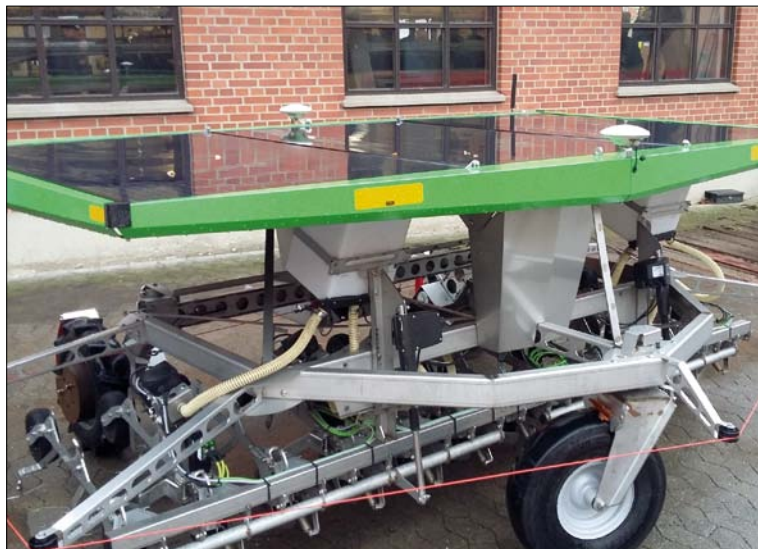
Obr. 5. Robotický nosič nářadí na solární pohon
