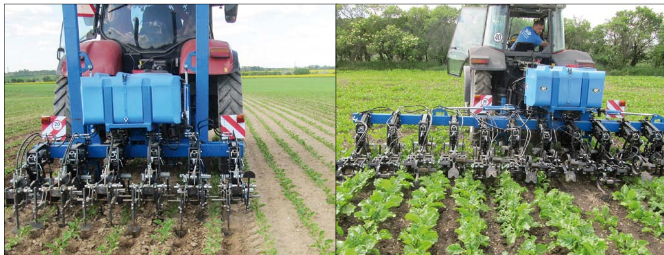
Obr. 7. Meziřádkové plečkování porostu cukrové řepy s důlkováním
