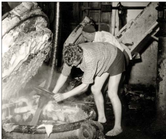
Obr. 5. Vyplachování difuzéru vodou tzv. Halfou (Hodonín II)
