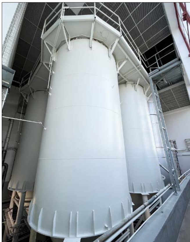
Obr. 8. Homogenizační síla pro výrobu dextrinu
