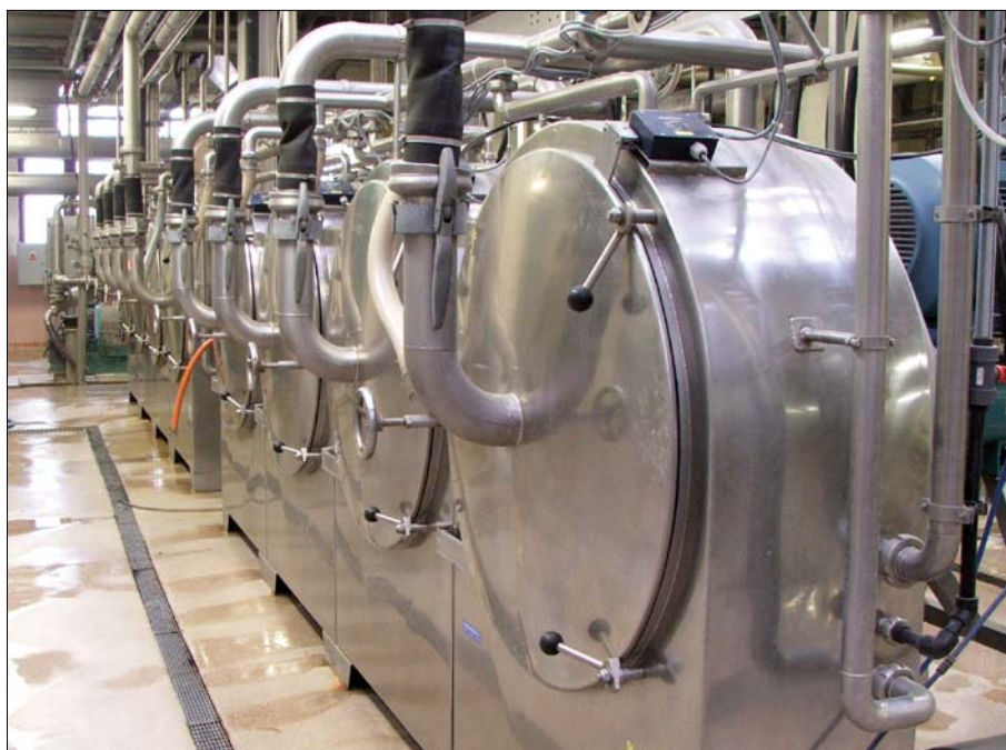
Obr. 6. Vypěrače vlákniny při výrobě bramborového škrobu
