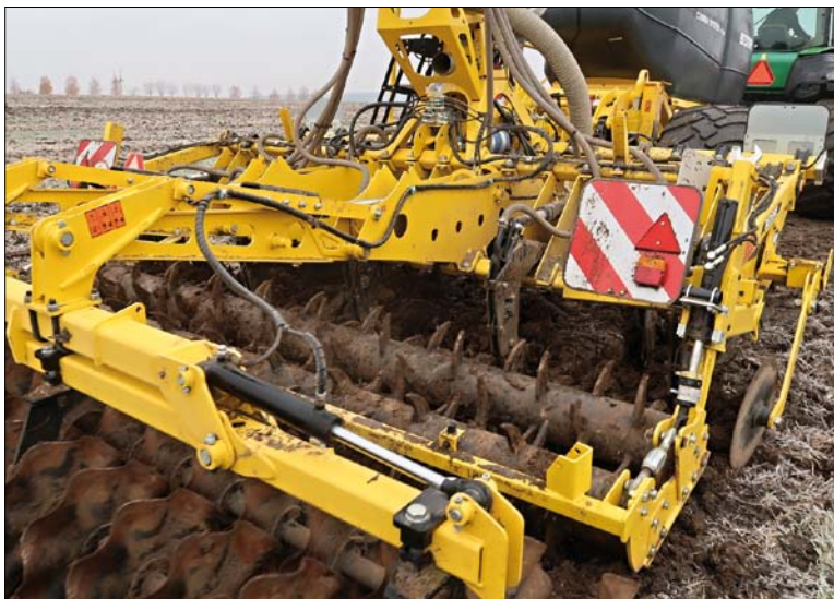
Obr. 4. Detail – zpracování půdy dlátovým pluhem s roztečí dlát 45 cm
