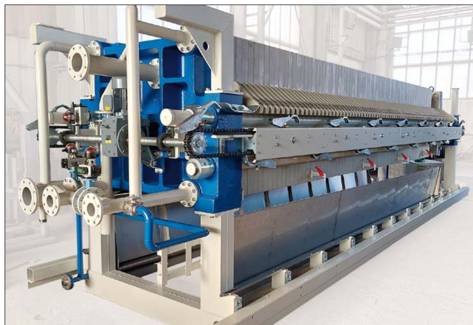
Obr. 6. Kalolis MEKO osazený membránovými deskami, dodavatel VUC Praha
